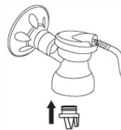
4. Coloque a válvula de bico de pato na saída inferior da válvula de três vias para garantir que não haja vazamentos.
