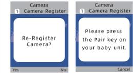
Pulse la tecla "Menu/OK" para acceder a la pantalla de registro de entrada. Pulse de nuevo la tecla "Menu/OK" para que aparezca el mensaje "¿Registrar la cámara?", y pulse la tecla de emparejamiento de la parte posterior de la unidad del bebé antes de que transcurran 10 segundos.
