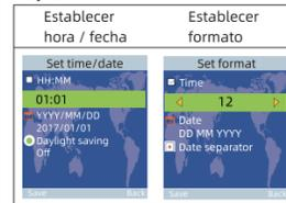
Presione la tecla hacia abajo para elegir el elemento, la tecla PTT para mover el cursor y la tecla hacia arriba para cambiar el valor.
