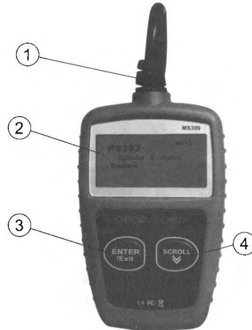
**1- CONECTOR OBD II** -- Conecta el lector de códigos al conector de enlace de datos del vehículo (DLC).
