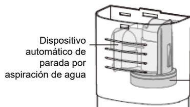
Dispositivo automático de parada por aspiración de agua
