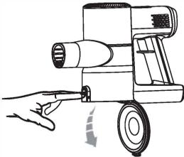
Cuando haya terminado, pulse el botón de desbloqueo situado en el lateral del cubo de la basura y vacíe el contenido.
