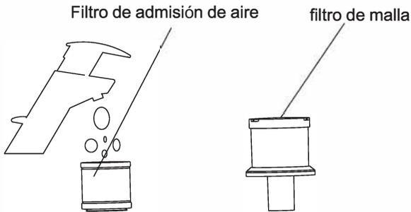
5.Por favor, seque el filtro HEPA y el filtro de malla completamente antes de volver a colocarlos en el cubo de la basura. El dustbin y el filtro de malla deben secarse al aire completamente antes de volver a instalarlos Cuando estén secos, monte el filtro en el filtro de malla.
