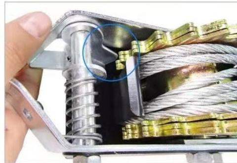
Paso 1: Presione el gatillo para liberar el engranaje y soltar el cable tensado.
