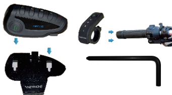
Schéma d'installation de la fixation du produit
