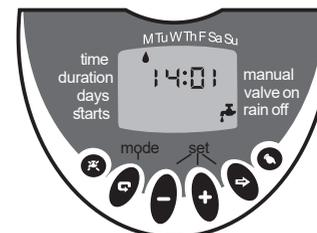
Para regar al instante presione . Presione para detener o funcionará durante el tiempo programado (si está configurado). El tiempo de riego predeterminado es de 5 minutos.
