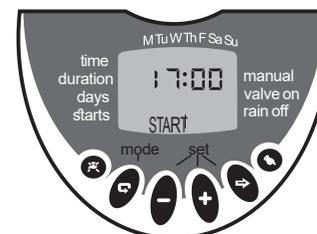
Presione y seleccione inicios (hora de inicio). Ajuste las horas usando o presione para ajustar los minutos. Puede configurar hasta 4 horas de inicio.
