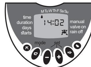
Se utiliza para apagar el temporizador en invierno o cuando llueve. Se mantendrán los horarios establecidos. Debe desactivar esta función para reanudar los horarios de riego programados. Presione hasta que aparezca el símbolo en la pantalla. Presione y el símbolo desaparecerá y se reanudarán los horarios de riego previamente programados.
