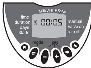
Presione y seleccione la duración . Ajuste las horas usando o presione para ajustar los minutos.
