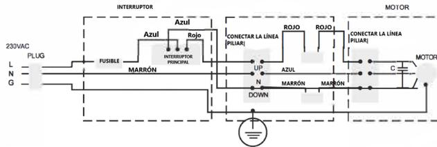
Si la pantalla motorizada funciona con control, consulte la figura siguiente para la conexión eléctrica.
