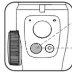
Encendido: presione el botón de encendido / apagado durante 3 segundos para encenderlo después de balancear el teléfono móvil.
