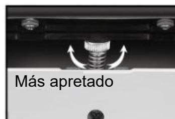
Si ocurre algún desplazamiento, presione o levante la tolva hasta que el cierre magnético mantenga la pieza en su lugar. Ajuste un espacio adecuado entre la tolva y el rodillo de alimentación de acuerdo con el giro del tornillo de ajuste de billetes. Gírelo a la izquierda para reducir el espacio y gírelo a la derecha para aumentarlo.
