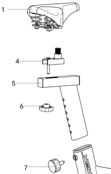
Inserte (5) el tubo de elevación acolchado en el marco principal. Desatornille el (7) tirador. El cojín (1) está bloqueado en el asiento de montaje del cojín (4), la almohadilla en la almohadilla plana grande (3), con (6) tuerca de bloqueo en (5) el tubo de elevación del cojín. 3, el pedal izquierdo L, derecho R respectivamente bloqueado en el marco principal (tenga en cuenta que el izquierdo y el derecho, y luego el hilo para apretar).
