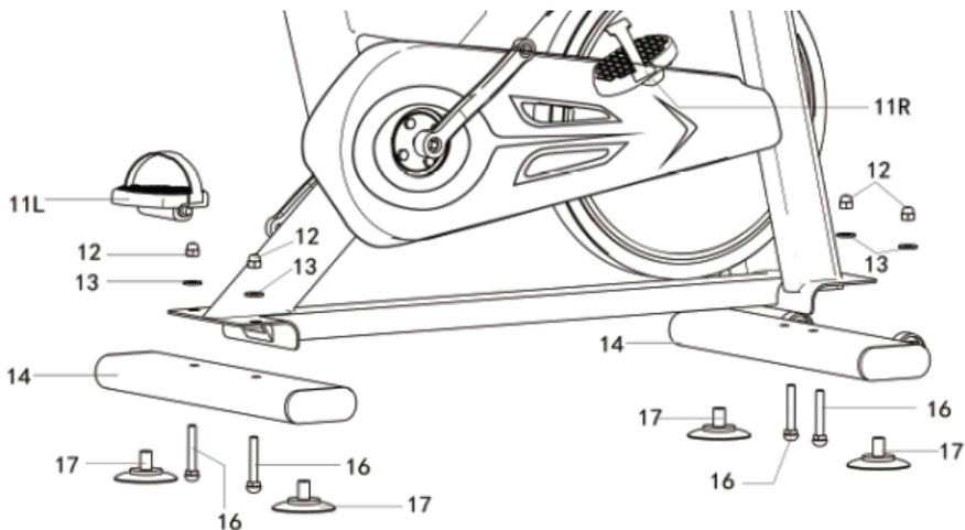
Abra la caja, retire el material anterior de la caja y coloque el marco principal plano en el suelo. Usando una llave abierta, los tornillos de cuello cuadrado de cabeza semicircular (16) se colocan en la arandela (13), la tuerca de la tapa (12) respectivamente el tubo del antepié (14) y el tubo de la pata trasera se bloquean en el marco principal (14).
